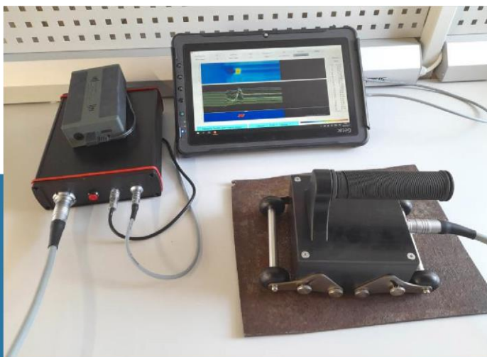
Дефектоскоп TiS 8C в сборе: электронный блок TiS 8C, аккумулятор, промышленный планшет, многоканальный сканер
