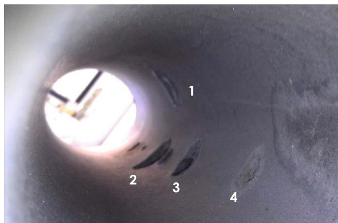
Дефекты на внутренней поверхности трубы печи
