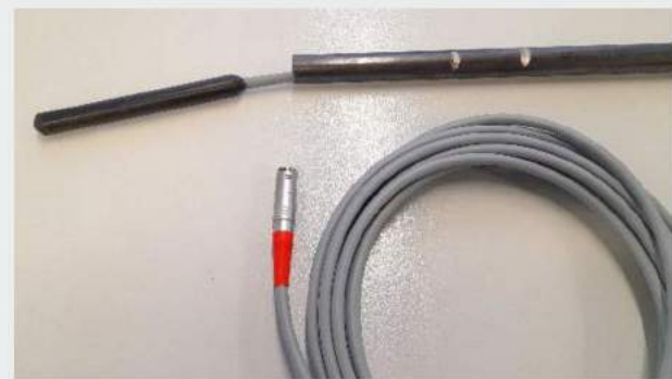
Стальная трубка с внутренним диаметром 22 мм, с толщиной стенки 2 мм
