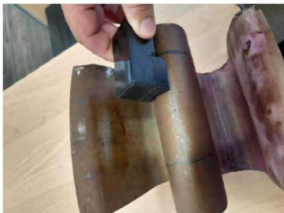
Сканирование по внешней поверхности сегмента подвижной части компенсатора
