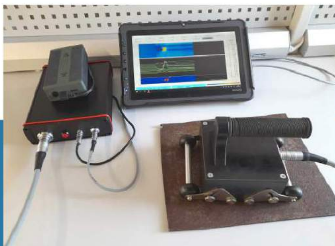
Дефектоскоп СКАВИС в сборе: электронный блок СКАВИС, аккумулятор, промышленный планшет, многоканальный сканер
